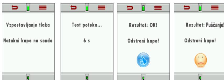
V kolikor test tesnosti ni uspešen, preverite cevi, kondenzatni lonček, tesnila in vse priključke. Če ne ugotovite napake, kontaktirajte MRU servis.
