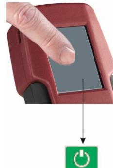
Po vklopu analizator takoj začne z ničlenjem. Sonda mora biti na svežem zraku in temperaturi okolice, senzor vleka pa pri tlaku okolice.
